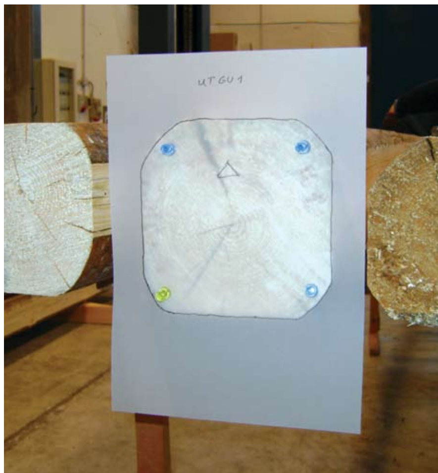
In pagina dall'alto vengono riportati i grafici a definizione delle travi UF/UT, rispettivamente per: smussi, eccentricità e differenza base-altezza. Sotto il rilievo della sezione effettiva
