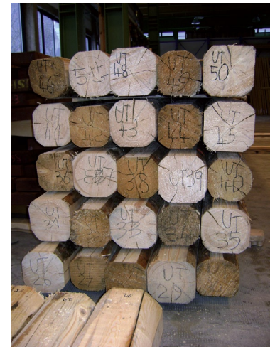
Bild 3: Behauholz nach Einschnittverfahren „Uso Trieste-UT“ vor der Klassifizierung
