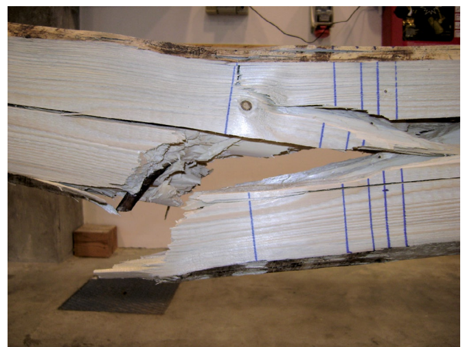
Bild 4: Bruchverhalten eines UF-Balkens mit eingewachsenem Ast (linke Bildhälfte)
